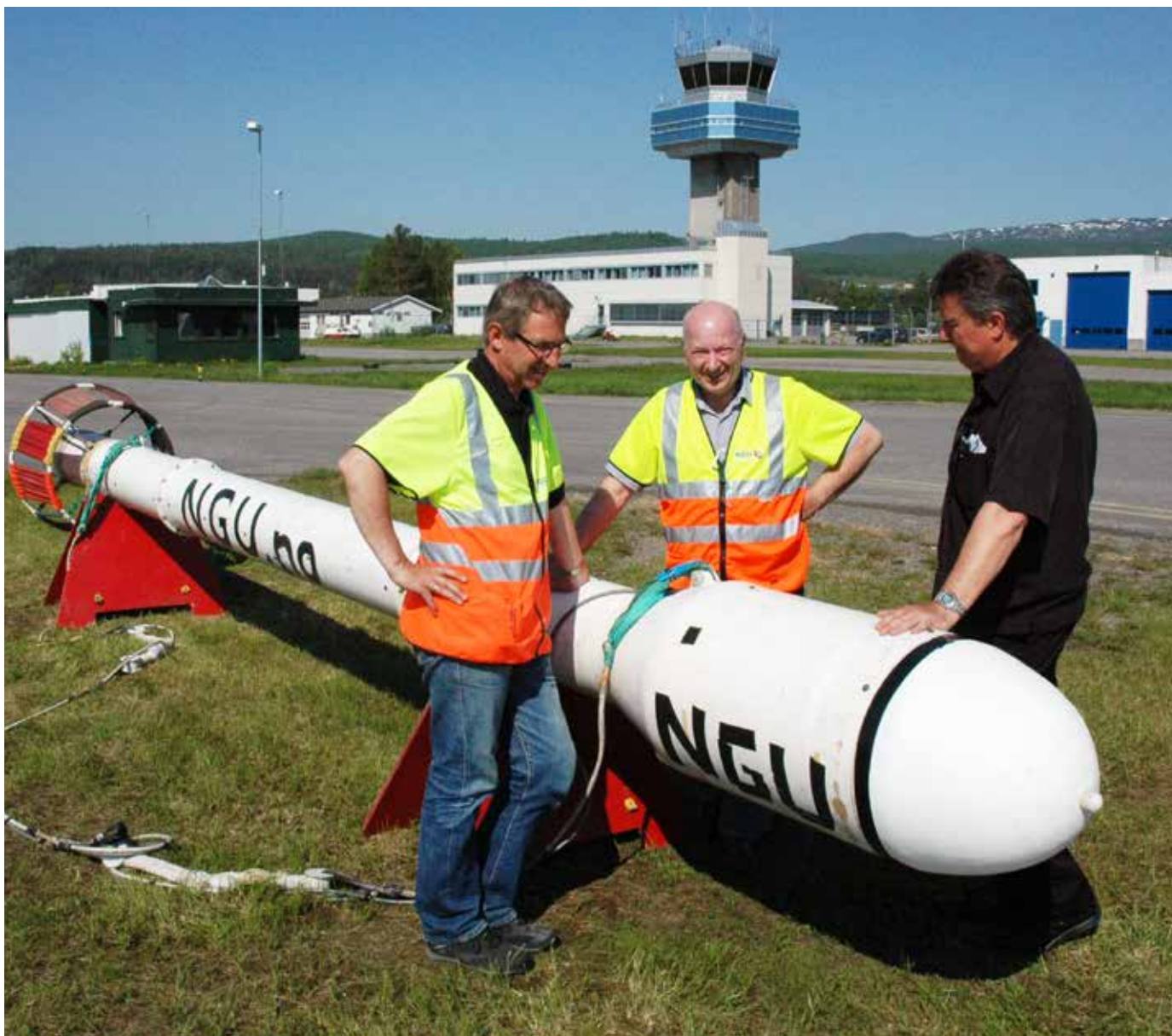
NGUs Rolf Lynum, Janusz Koziel og Jan Steinar Rønning ved målesonden som registrerer variasjoner i magnetfelt og elektrisk ledningsevne i berggrunnen.
